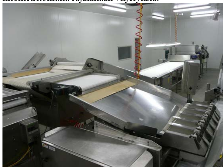
Tilan lajittelu- ja puhdistusketju pensasmustikalle.
