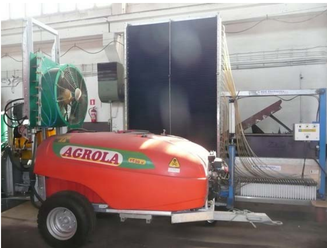
Agrola-ruiskun takana ruiskujen testaukseen käytettävä seinä, jonka eri lohkoilta kerätään aine talteen tasaisuuden mittausta varten.
