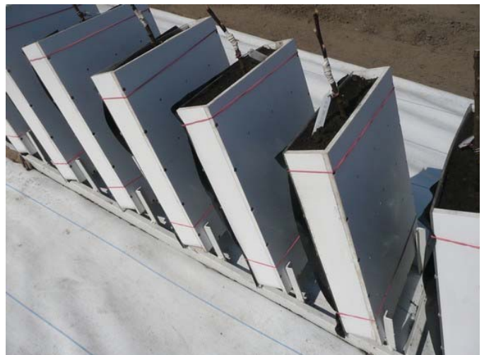
Perusrunkojen juurten profiilia tutkitaan kesän ajan ”kasetissa”, jossa toinen puoli on läpinäkyvä pleksi peitettynä mustalla muovilla.
